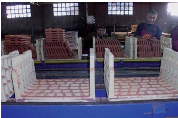
Slika 5: Stari način klasiranja pečenog crijepa
