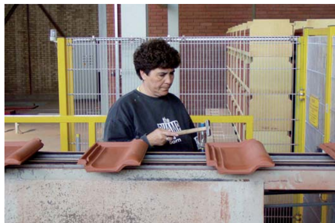
Slika 6: Novi način klasiranja pečenog crijepa
